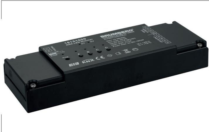
LED-Dimmer 12-24 V DC, dimmbar. LED-Dimmer-Serie für Konstantspannungsbetrieb (12-24 V DC) über 4 Kanäle (ein- oder mehrfarbig). Die Verkabelung erfolgt Fassung: ohne, Material: Kunststoff, Schutzart: nach DIN EN 60529: IP20, Schutzklasse: (EN 61140) III, Spannung: 12V 24V, Leistung: 24-240W, .
