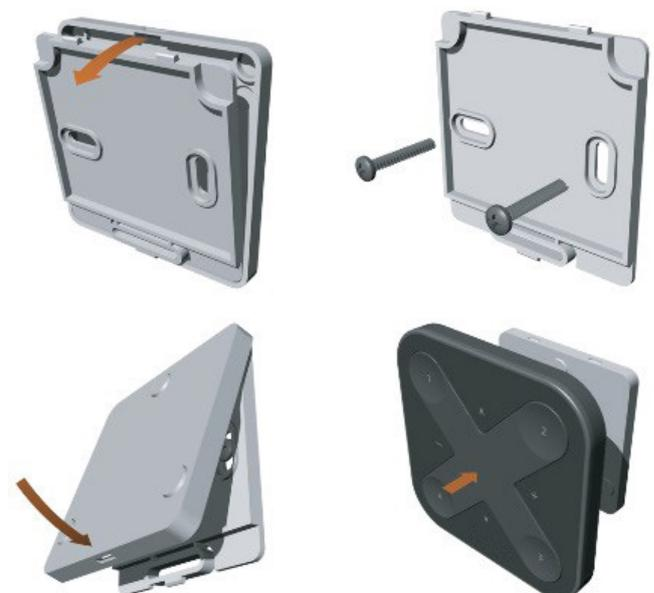
Xpress-LR ist für eine leichte Befestigung an der Wandmontageplatte mit Magneten ausgestattet. Die Wandmontageplatte ist im Lieferumfang enthalten.
