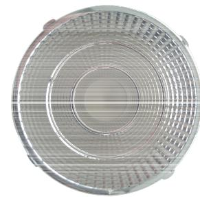
Reflector für geringeren Abstrahlwinkel, geeignet für LED-Einbauspot, Abstrahlwinkel: 15 °, Durchmesser: Ø76mm
