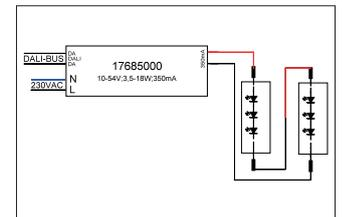
LED-Konverter 350 mA, DALI dimmbar (digital) Dieser Konverter ist durch Sicherungseinrichtungen gegen Überspannung und Kurzschluss sowie thermische und elektrische Überlastung geschützt. Die Eingangs- und die Ausgangsklemme ist für Leitungen mit einem Querschnitt von 0,75-1,5 mm<sup>2</sup> geeignet. Material: Kunststoff, Schutzart: nach DIN EN 60529: IP20, Schutzklasse: (EN 61140) II, Spannung: 230V AC 50Hz, Leistung: 18W, Art der Dimmung: DALI-2.
