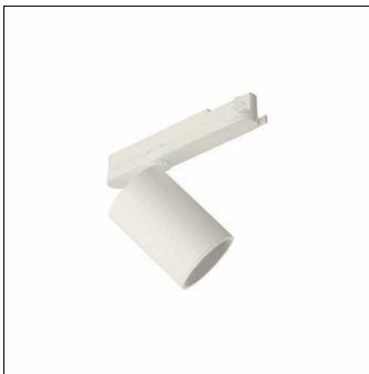
Spot 21, Richtstrahler, Lichtlenkung mit Reflektor, aus Aluminium, LED Bemessungslichtstrom: 3.000lm, Lichtfarbe: 930, Vorschaltgerät: EVG, mit 3-Phasen-Adapter, Netzanschluss: 220..240V, AC, 50/60Hz, Gehäuse, aus Aluminium, weiß, Länge: 228mm, Durchmesser: 90mm, Adapter, aus Kunststoff, Schutzart (gesamt): IP20, Schutzklasse (gesamt): SK I (Schutzerdung), Prüfzeichen: CE, Schlagfestigkeit: IK02, Verpackungseinheit: 1 Stück
