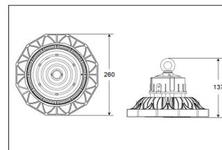
SOL Highbay 80, schwarz, rund. Pendelmontage, Deckenmontage.. Montageart: Pendelmontage, Montageort: Deckenmontage, Material: Aluminium / Polycarbonat, Schutzart: nach DIN EN 60529: IP65, Schutzklasse: (EN 61140) I, Leistung: 80,00W, Lichtstrom: 12.800lm, Farbtemperatur: 4000 K Abstrahlwinkel: 120°, Dimmbar: Ja, Art der Dimmung: DALI-2.
