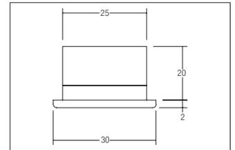
LED-Lichtpunkt IP43, chrom, rund. Ausgeführt in kompakter Bauform für werkzeuglose Schnellmontage zum Deckeneinbau. Fassung: Plug&Play 350mA, Montageart: Einbaumontage, Montageort: Deckenmontage, Material: Aluminium / Kunststoff, Schutzart: nach DIN EN 60529: IP43\*, Schutzklasse: (EN 61140) III, Strom: 350 mA, Leistung: 1,2W, Anzahl der Leuchtmittel / Fassungen: 1.0 Stk, Lichtstrom: 40lm, Farbtemperatur: 3000K, Abstrahlwinkel: 30°, Verstellbarkeit: nicht verstellbar, .
