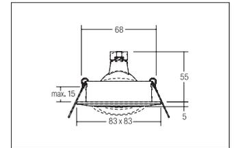
Einbaustrahler, weiß, quadratisch. Ausgeführt in kompakter Bauform für werkzeuglose Schnellmontage zum Deckeneinbau. Fassung: GX5,3, Montageart: Einbaumontage, Montageort: Deckenmontage, Material: Guss, Schutzart: nach DIN EN 60529: IP20, Schutzklasse: (EN 61140) III, Spannung: 12V, Leistung: max. 50W, Anzahl der Leuchtmittel / Fassungen: 1.0 Stk, Verstellbarkeit: schwenkbar, ohne Betriebsgerät, Art der Dimmung: sonstige, .
