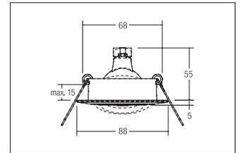
Einbaustrahler, weiß, rund. Ausgeführt in kompakter Bauform für werkzeuglose Schnellmontage zum Deckeneinbau. Fassung: GX5,3, Montageart: Einbaumontage, Montageort: Deckenmontage, Material: Guss, Schutzart: nach DIN EN 60529: IP20, Schutzklasse: (EN 61140) III, Spannung: 12V, Leistung: max. 50W, Anzahl der Leuchtmittel / Fassungen: 1.0 Stk, Verstellbarkeit: schwenkbar, ohne Betriebsgerät, Art der Dimmung: sonstige, .
