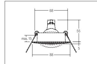
Einbaustrahler, gold, rund. Ausgeführt in kompakter Bauform für werkzeuglose Schnellmontage zum Deckeneinbau. Fassung: GX5,3, Montageart: Einbaumontage, Montageort: Deckenmontage, Material: Guss, Schutzart: nach DIN EN 60529: IP20, Schutzklasse: (EN 61140) III, Spannung: 12V, Leistung: max. 50W, Anzahl der Leuchtmittel / Fassungen: 1.0 Stk, Verstellbarkeit: schwenkbar, ohne Betriebsgerät, Art der Dimmung: sonstige, .
