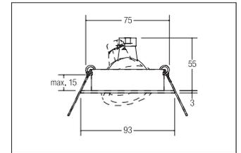
Einbaustrahler, aluminium, rund. Ausgeführt in kompakter Bauform für werkzeuglose Schnellmontage zum Deckeneinbau. Fassung: GX5,3, Montageart: Einbaumontage, Montageort: Deckenmontage, Material: Aluminium, Schutzart: nach DIN EN 60529: IP20, Schutzklasse: (EN 61140) III, Spannung: 12V, Leistung: max. 50W, Anzahl der Leuchtmittel / Fassungen: 1.0 Stk, Verstellbarkeit: schwenkbar, ohne Betriebsgerät, Art der Dimmung: sonstige, .
