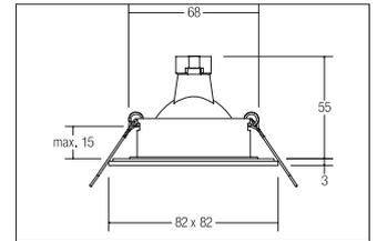
Einbaudownlight V4A IP54, edelstahl, quadratisch. Ausgeführt in kompakter Bauform für werkzeuglose Schnellmontage zum Deckeneinbau. Fassung: GX5,3, Montageart: Einbaumontage, Montageort: Deckenmontage, Material: Edelstahl / Glas, Schutzart: nach DIN EN 60529: IP54\*, Schutzklasse: (EN 61140) III, Spannung: 12V, Leistung: max. 35W, Anzahl der Leuchtmittel / Fassungen: 1.0 Stk, Verstellbarkeit: nicht verstellbar, ohne Betriebsgerät, Art der Dimmung: sonstige, .
