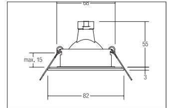
Einbaudownlight V4A IP54, edelstahl, rund. Ausgeführt in kompakter Bauform für werkzeuglose Schnellmontage zum Deckeneinbau. Fassung: GX5,3, Montageart: Einbaumontage, Montageort: Deckenmontage, Material: Edelstahl / Glas, Schutzart: nach DIN EN 60529: IP54\*, Schutzklasse: (EN 61140) III, Spannung: 12V, Leistung: max. 35W, Anzahl der Leuchtmittel / Fassungen: 1.0 Stk, Verstellbarkeit: nicht verstellbar, ohne Betriebsgerät, Art der Dimmung: sonstige, .
