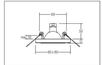
Einbaudownlight, chrom, quadratisch. Ausgeführt in kompakter Bauform für werkzeuglose Schnellmontage zum Deckeneinbau. Fassung: GX5,3, Montageart: Einbaumontage, Montageort: Deckenmontage, Material: Aluminiumguss / Glas, Schutzart: nach DIN EN 60529: IP20, Schutzklasse: (EN 61140) III, Spannung: 12V, Leistung: max. 50W, Anzahl der Leuchtmittel / Fassungen: 1.0 Stk, Verstellbarkeit: nicht verstellbar, ohne Betriebsgerät, Art der Dimmung: sonstige, .
