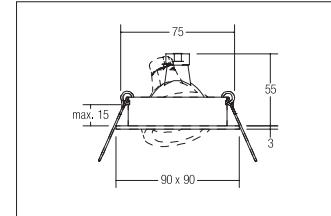
Einbaustrahler, aluminium, quadratisch. Ausgeführt in kompakter Bauform für werkzeuglose Schnellmontage zum Deckeneinbau. Fassung: GX5,3, Montageart: Einbaumontage, Montageort: Deckenmontage, Material: Aluminium, Schutzart: nach DIN EN 60529: IP20, Schutzklasse: (EN 61140) III, Spannung: 12V, Leistung: max. 50W, Anzahl der Leuchtmittel / Fassungen: 1.0 Stk, Verstellbarkeit: schwenkbar, ohne Betriebsgerät, Art der Dimmung: sonstige, .
