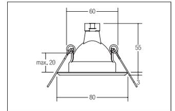
Einbaudownlight, chrom, rund. Ausgeführt in kompakter Bauform für werkzeuglose Schnellmontage zum Deckeneinbau. Fassung: GX5,3, Montageart: Einbaumontage, Montageort: Deckenmontage, Material: Stahl, Schutzart: nach DIN EN 60529: IP20, Schutzklasse: (EN 61140) III, Spannung: 12V, Leistung: max. 50W, Anzahl der Leuchtmittel / Fassungen: 1.0 Stk, Verstellbarkeit: nicht verstellbar, ohne Betriebsgerät, Art der Dimmung: sonstige, .
