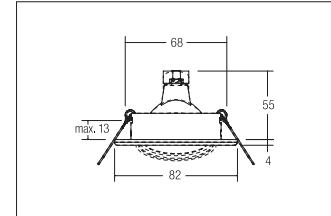
Einbaustrahler, chrom, rund. Ausgeführt in kompakter Bauform für werkzeuglose Schnellmontage zum Deckeneinbau. Fassung: GX5,3, Montageart: Einbaumontage, Montageort: Deckenmontage, Material: Stahl / Messing, Schutzart: nach DIN EN 60529: IP20, Schutzklasse: (EN 61140) III, Spannung: 12V, Leistung: max. 50W, Anzahl der Leuchtmittel / Fassungen: 1.0 Stk, Verstellbarkeit: schwenkbar, ohne Betriebsgerät, Art der Dimmung: sonstige, .
