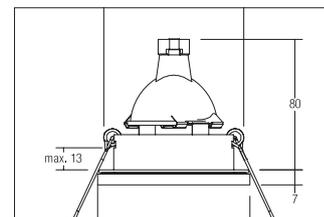
Einbaudownlight IP65, aluminium, rund. Ausgeführt in kompakter Bauform für werkzeuglose Schnellmontage zum Deckeneinbau. Fassung: GX5,3, Montageart: Einbaumontage, Montageort: Deckenmontage, Material: Guss / Glas, Schutzart: nach DIN EN 60529: IP65\*, Schutzklasse: (EN 61140) III, Spannung: 12V, Leistung: max. 50W, Anzahl der Leuchtmittel / Fassungen: 1.0 Stk, Verstellbarkeit: nicht verstellbar, ohne Betriebsgerät, Art der Dimmung: sonstige, .
