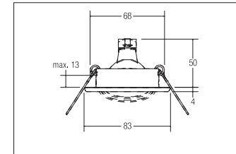
Einbaustrahler, edelstahl, rund. Ausgeführt in kompakter Bauform für werkzeuglose Schnellmontage zum Deckeneinbau. Fassung: GX5,3, Montageart: Einbaumontage, Montageort: Deckenmontage, Material: Edelstahl, Schutzart: nach DIN EN 60529: IP20, Schutzklasse: (EN 61140) III, Spannung: 12V, Leistung: max. 50W, Anzahl der Leuchtmittel / Fassungen: 1.0 Stk, Verstellbarkeit: schwenkbar, ohne Betriebsgerät, Art der Dimmung: sonstige, .
