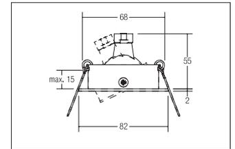
Einbaustrahler V4A, edelstahl, quadratisch. Ausgeführt in kompakter Bauform für werkzeuglose Schnellmontage zum Deckeneinbau. Fassung: GX5,3, Montageart: Einbaumontage, Montageort: Deckenmontage, Material: Edelstahl, Schutzart: nach DIN EN 60529: IP20, Schutzklasse: (EN 61140) III, Spannung: 12V, Leistung: max. 50W, Anzahl der Leuchtmittel / Fassungen: 1.0 Stk, Verstellbarkeit: schwenkbar, ohne Betriebsgerät, Art der Dimmung: sonstige, .
