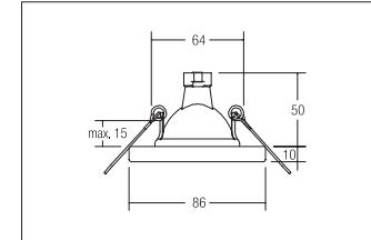
Einbaudownlight IP65, edelstahl, rund. Ausgeführt in kompakter Bauform für werkzeuglose Schnellmontage zum Deckeneinbau. Fassung: GX5,3, Montageart: Einbaumontage, Montageort: Deckenmontage, Material: Edelstahl / Glas, Schutzart: nach DIN EN 60529: IP65\*, Schutzklasse: (EN 61140) III, Spannung: 12V, Leistung: max. 35W, Anzahl der Leuchtmittel / Fassungen: 1.0 Stk, Verstellbarkeit: nicht verstellbar, ohne Betriebsgerät, Art der Dimmung: sonstige, .
