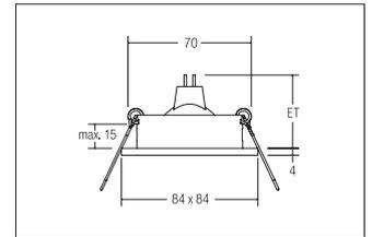
Einbaustrahler, weiß, quadratisch. Ausgeführt in kompakter Bauform für werkzeuglose Schnellmontage zum Deckeneinbau. Fassung: ohne, Montageart: Einbaumontage, Montageort: Deckenmontage, Material: Aluminiumguss, Schutzart: nach DIN EN 60529: IP20, Schutzklasse: (EN 61140) III, Spannung: 12V, Leistung: 50W, Anzahl der Leuchtmittel / Fassungen: 1.0 Stk, Verstellbarkeit: schwenkbar, ohne Betriebsgerät, .
