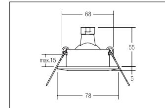
Einbaudownlight, weiß, rund. Ausgeführt in kompakter Bauform für werkzeuglose Schnellmontage zum Deckeneinbau. Fassung: GX5,3, Montageart: Einbaumontage, Montageort: Deckenmontage, Material: Aluminiumguss, Schutzart: nach DIN EN 60529: IP20, Schutzklasse: (EN 61140) III, Spannung: 12V, Leistung: max. 50W, Anzahl der Leuchtmittel / Fassungen: 1.0 Stk, Verstellbarkeit: nicht verstellbar, ohne Betriebsgerät, Art der Dimmung: sonstige, .
