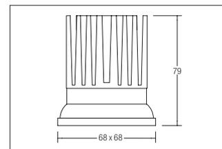
LED-System-Downlight COUPLED, IP44, quadratisch, weiß. Ausgeführt in kompakter Bauform für werkzeuglose Schnellmontage zum Deckeneinbau. Montage nur zzgl. Einputz- oder Einbaurahmen 82040170, 82041170, 82042170 oder 82043170 möglich.
