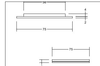
LED-Einbau- / Anbaudownlight, rund. Ausgeführt in kompakter Bauform für werkzeuglose Schnellmontage zum Deckeneinbau. Diese Leuchte ist sowohl als Einbau- (Lochausschnitt: 56 mm, Einbautiefe: 3,5 mm, Aufbauhöhe: 2,2 mm), als auch als Anbauleuchte (Gesamthöhe: 5,9 mm) durch mitgeliefertes Anbaugehäuse zu verwenden.
