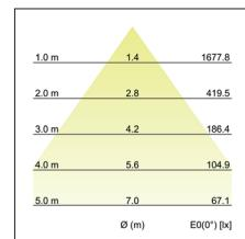
LED-Einbaudownlight, strukturweiss, rund. Ausgeführt in kompakter Bauform für werkzeuglose Schnellmontage zum Deckeneinbau. Montageart: Einbaumontage, Montageort: Deckenmontage, Material: Aluminium / Kunststoff, Schutzart: nach DIN EN 60529: IP20, Schutzklasse: (EN 61140) II, Spannung: 230V AC 50Hz, Leistung: 35W, Anzahl der Leuchtmittel / Fassungen: 1.0 Stk, Lichtstrom: 2.370lm, Lichtfarbe: weiß, Abstrahlwinkel: 70°, Verstellbarkeit: nicht verstellbar, mit Betriebsgerät, Art der Dimmung: DALI .
