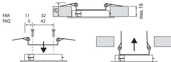
Schenkelfedern nach oben drücken. Leuchte in die Einbaueffnung einsetzen.
