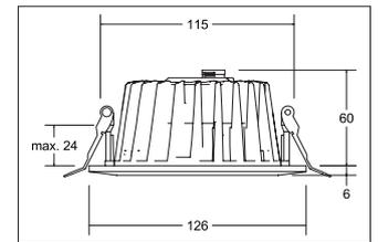
LED-Einbaudownlight, schaltbar, weiss, rund. Ausgeführt in kompakter Bauform für werkzeuglose Schnellmontage zum Decken-einbau Montageart: Einbaumontage, Montageort: Deckenmontage, Material: Aluminium / Glas / Kunststoff, Schutzart: nach DIN EN 60529: IP20, Schutzklasse: (EN 61140) II, Spannung: 230V AC 50Hz, Leistung: 20W, Anzahl der Leuchtmittel / Fassungen: 1.0 Stk, Lichtfarbe: weiß, Abstrahlwinkel: 40°, Verstellbarkeit: nicht verstellbar, mit Betriebsgerät, Art der Dimmung: schaltbar .
