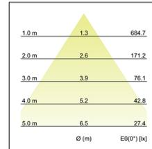
LED-Einbaudownlight, strukturweiss, rund. Ausgeführt in kompakter Bauform für werkzeuglose Schnellmontage zum Deckeneinbau. Montageart: Einbaumontage, Montageort: Deckenmontage, Material: Aluminium / Stahl / Kunststoff, Schutzart: nach DIN EN 60529: IP20, Schutzklasse: (EN 61140) II, Spannung: 230V AC 50Hz, Leistung: 11W, Anzahl der Leuchtmittel / Fassungen: 1.0 Stk, Lichtfarbe: weiß, Abstrahlwinkel: 65°, Verstellbarkeit: nicht verstellbar, mit Betriebsgerät, Art der Dimmung: schaltbar .
