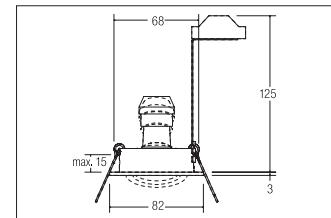
Hochvolt-Einbaustrahler GU10, titan. Ausgeführt in kompakter Bauform für werkzeuglose Schnellmontage zum Deckeneinbau. Inkl. Hochvoltbügel zur normgerechten Zugentlastung. Fassung: GU10, Montageart: Einbaumontage, Montageort: Deckenmontage, Material: Aluminium, Schutzart: nach DIN EN 60529: IP20, Schutzklasse: (EN 61140) II, Spannung: 230V AC 50Hz, Leistung: max. 50W, Anzahl der Leuchtmittel / Fassungen: 1.0 Stk, Verstellbarkeit: schwenkbar, ohne Betriebsgerät, Art der Dimmung: sonstige, .
