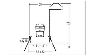
Hochvolt-Einbaustrahler GU10, chrom. Ausgeführt in kompakter Bauform für werkzeuglose Schnellmontage zum Deckeneinbau. Inkl. Hochvoltbügel zur normgerechten Zugentlastung. Fassung: GU10, Montageart: Einbaumontage, Montageort: Deckenmontage, Material: Aluminium, Schutzart: nach DIN EN 60529: IP20, Schutzklasse: (EN 61140) II, Spannung: 230V AC 50Hz, Leistung: max. 50W, Anzahl der Leuchtmittel / Fassungen: 1.0 Stk, Verstellbarkeit: schwenkbar, ohne Betriebsgerät, Art der Dimmung: sonstige, .
