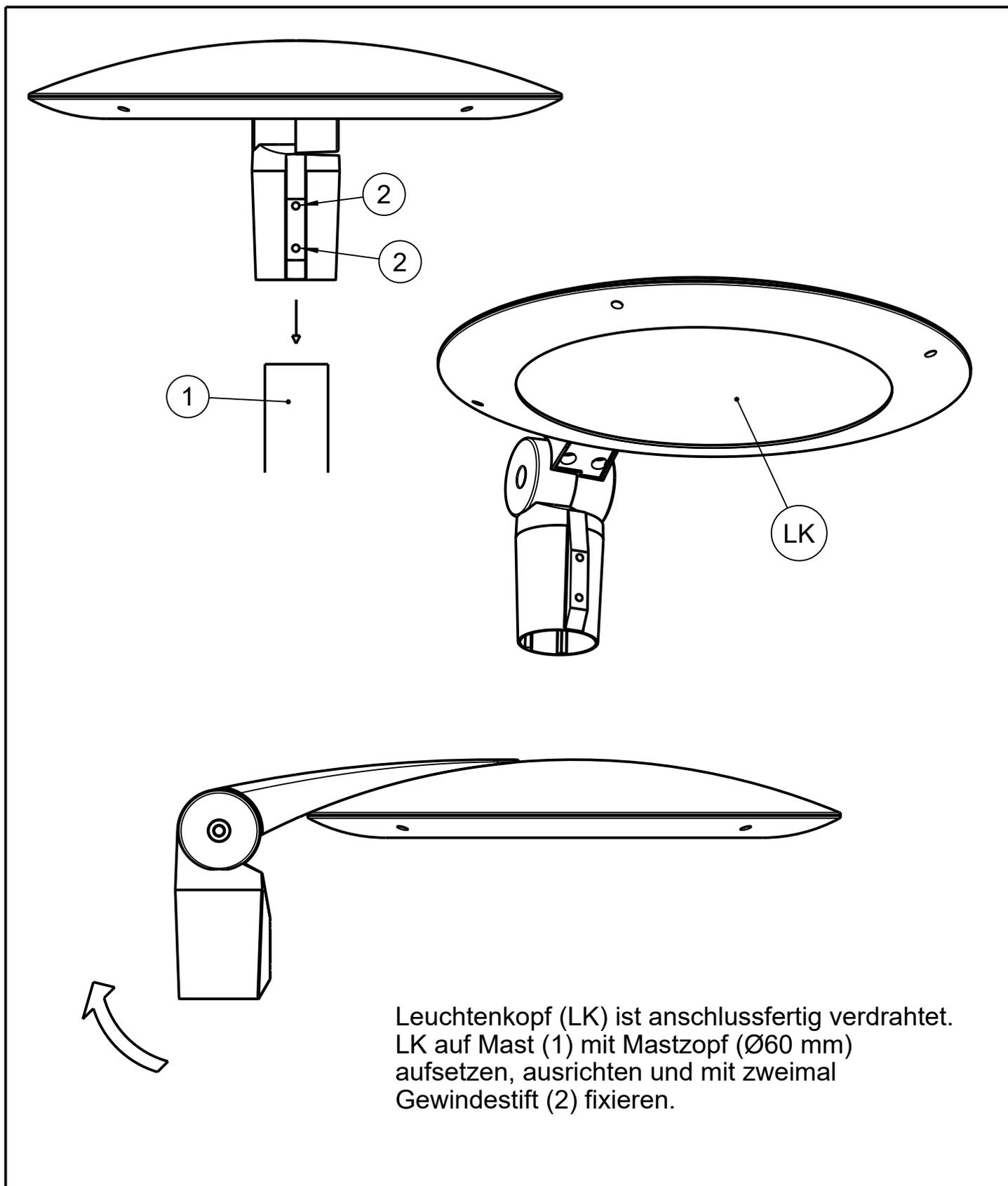
Leuchtenkopf (LK) ist anschlussfertig verdrahtet.
