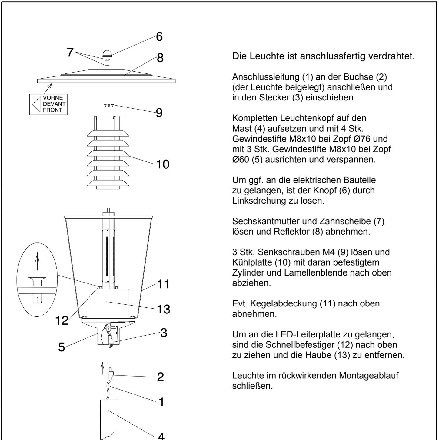
Die Leuchte ist anschlussfertig verdrahtet.
