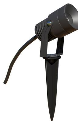
Die Leuchte kann entweder mittels des montierten Bügels direkt auf dem Untergrund, oder optional mit dem mitgeliefertem Erdspieß im weichen Untergrund montiert werden. Am Strahler befindet sich eine 1,5m lange Anschlussleitung mit freien Aderenden. Der Schwenkwinkel der Leuchte beträgt 45°. Der Erdspieß hat eine Länge von 170mm.
