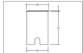
LED-Bodeneinbauleuchte HYBRIDE MINI, V4A, IP65, edelstahl, rund. Einbaumontage, Bodenmontage. Montageart: Einbaumontage, Montageort: Bodenmontage, Material: Edelstahl / Aluminium / Glas, Schutzart: nach DIN EN 60529: IP65, Schutzklasse: (EN 61140) III, Spannung: 24V, Leistung: 1,4W, Anzahl der Leuchtmittel / Fassungen: 1.0 Stk, Lichtstrom: 18lm, Farbtemperatur: 3000K, Lichtfarbe: weiß, Abstrahlwinkel: 100°, ohne Betriebsgerät.
