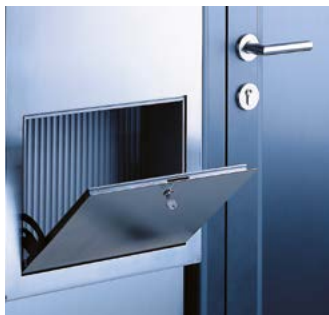
Komfortabler Postempfang: Öffnung nach vorne gegen herabfallende Post, Kunststoffklimabox gegen Kondensfeuchtigkeit und Rillenboden gegen durchweichte Sendungen, falls doch einmal Wasser eintritt.
