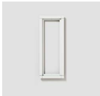
KR 611-3/1-0 Kombirahmen aus Aluminium-Strangpressprofilen, pulverbeschichtet bzw. lackiert, umschließt die Funktionsmodule und deckt die Putznut ab. Eine umlaufende Dichtung verhindert das Eindringen von Wasser. Abmessungen (mm) B x H x T: 131 x 331 x 15
