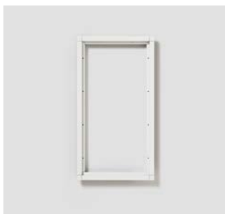
KR 611-4/2-0 Kombirahmen aus Aluminium-Strangpressprofilen, pulverbeschichtet bzw. lackiert, umschließt die Funktionsmodule und deckt die Putznut ab. Eine umlaufende Dichtung verhindert das Eindringen von Wasser. Abmessungen (mm) B x H x T: 231 x 431 x 15
