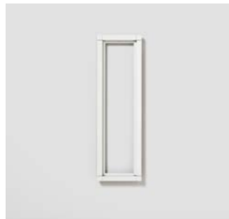
KR 611-4/1-0 Kombirahmen aus Aluminium-Strangpressprofilen, pulverbeschichtet bzw. lackiert, umschließt die Funktionsmodule und deckt die Putznut ab. Eine umlaufende Dichtung verhindert das Eindringen von Wasser. Abmessungen (mm) B x H x T: 131 x 431 x 15
