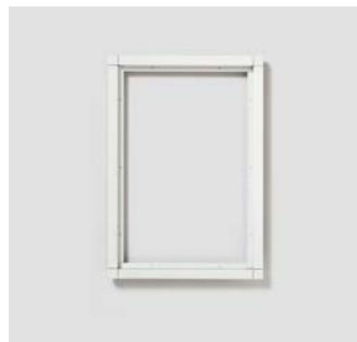
KR 611-3/2-0 Kombirahmen aus Aluminium-Strangpressprofilen, pulverbeschichtet bzw. lackiert, umschließt die Funktionsmodule und deckt die Putznut ab. Eine umlaufende Dichtung verhindert das Eindringen von Wasser. Abmessungen (mm) B x H x T: 231 x 331 x 15
