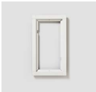
KR 611-2/1-0 Kombirahmen aus Polycarbonat lackiert, umschließt die Funktionsmodule und deckt die Putznut ab. Eine umlaufende Dichtung verhindert das Eindringen von Wasser. Abmessungen (mm) B x H x T: 131 x 231 x 15
