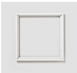
KR 611-3/3-0 Kombirahmen aus Aluminium-Strangpressprofilen, pulverbeschichtet bzw. lackiert, umschließt die Funktionsmodule und deckt die Putznut ab. Eine umlaufende Dichtung verhindert das Eindringen von Wasser. Abmessungen (mm) B x H x T: 331 x 331 x 15
