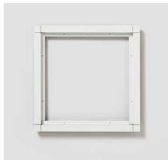
KR 611-2/2-0 Kombirahmen aus Aluminium-Strangpressprofilen, pulverbeschichtet bzw. lackiert, umschließt die Funktionsmodule und deckt die Putznut ab. Eine umlaufende Dichtung verhindert das Eindringen von Wasser. Abmessungen (mm) B x H x T: 231 x 231 x 15
