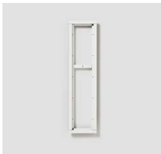
KR 611-5/1-0 Kombirahmen aus Aluminium-Strangpressprofilen, pulverbeschichtet bzw. lackiert, umschließt die Funktionsmodule und deckt die Putznut ab. Eine umlaufende Dichtung verhindert das Eindringen von Wasser. Abmessungen (mm) B x H x T: 131 x 531 x 38
