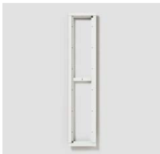
KR 611-6/1-0 Kombirahmen aus Aluminium-Strangpressprofilen, pulverbeschichtet bzw. lackiert, umschließt die Funktionsmodule und deckt die Putznut ab. Eine umlaufende Dichtung verhindert das Eindringen von Wasser. Abmessungen (mm) B x H x T: 131 x 631 x 38
