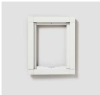
KR 611-1/1-0 Kombirahmen aus Aluminium-Strangpressprofilen, pulverbeschichtet bzw. lackiert, umschließt die Funktionsmodule und deckt die Putznut ab. Eine umlaufende Dichtung verhindert das Eindringen von Wasser. Abmessungen (mm) B x H x T: 131 x 163 x 15
