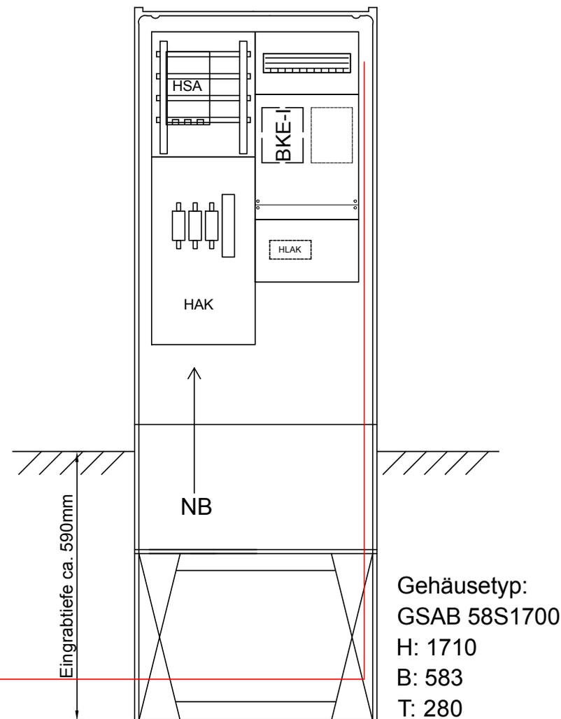
Hinweis: Für Anlagen mit Freigabesteuerung (z.B. Wärmepumpen ) wird die Schaltuhr im Raum für Zusatzeinrichtungen eingebaut. Erläuterungen zu den TAB NS Nord 5.1 2012
