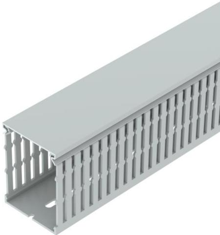
Halogenfreier Verdrahtungskanal inkl. Oberteil und Bodenlochung zur waagerechten und senkrechten Verlegung elektrischer Kabel und Leitungen im Schaltschrank. Mit doppelseitigen Klebeband am Kanalboden als Montagehilfe. Ausführung als metrischer Kanal. Das Ausbrechen der Stege erfolgt werkzeuglos. Sonderlängen auf Anfrage.
