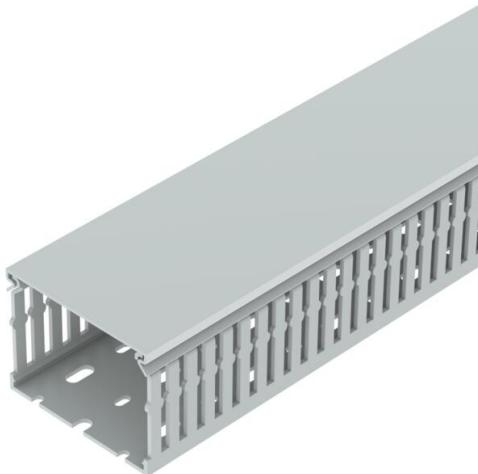
Halogenfreier Verdrahtungskanal inkl. Oberteil und Bodenlochung zur waagerechten und senkrechten Verlegung elektrischer Kabel und Leitungen im Schaltschrank. Mit doppelseitigen Klebeband am Kanalboden als Montagehilfe. Ausführung als metrischer Kanal. Das Ausbrechen der Stege erfolgt werkzeuglos. Sonderlängen auf Anfrage.
