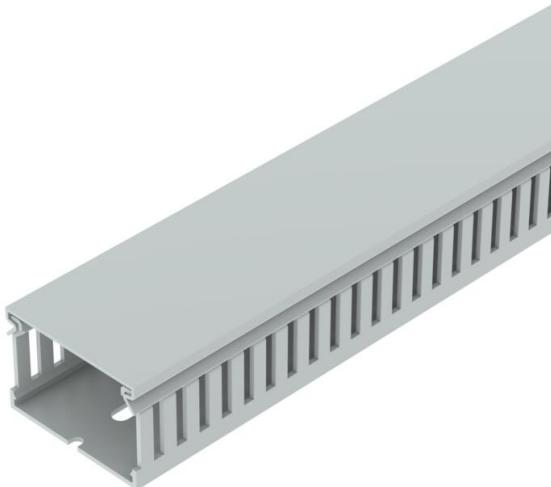
Halogenfreier Verdrahtungskanal inkl. Oberteil und Bodenlochung zur waagerechten und senkrechten Verlegung elektrischer Kabel und Leitungen im Schaltschrank. Mit doppelseitigen Klebeband am Kanalboden als Montagehilfe. Ausführung als metrischer Kanal. Das Ausbrechen der Stege erfolgt werkzeuglos. Sonderlängen auf Anfrage.
