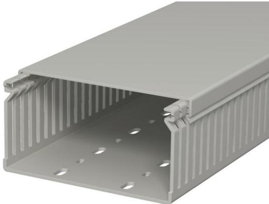
Verdrahtungskanal inkl. Oberteil und Bodenlochung zur waagerechten und senkrechten Verlegung elektrischer Kabel und Leitungen im Schaltschrank. Ausführung als metrischer Kanal. Das Nennmaß der Systemgröße entspricht dem Innenmaß der Kanäle. Das Ausbrechen der Stege erfolgt werkzeuglos. Bodenbündiges Ausführen ist durch Sollbruchstellen möglich. Geprüft nach DIN EN 50085-2-3. Sonderlängen auf Anfrage.
