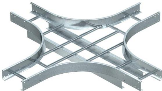
Kreuzung, horizontal, für alle Weitspannkabelleitern mit der Seitenhöhe 110 mm. Zur weiteren Stabilisierung sollten im Bereich der Formteile Unterstützungen vorgesehen werden.
