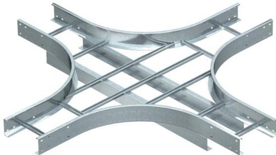
Kreuzung, horizontal, für alle Weitspannkabellitern mit der Seitenhöhe 110 mm. Zur weiteren Stabilisierung sollten im Bereich der Formteile Unterstützungen vorgesehen werden.
