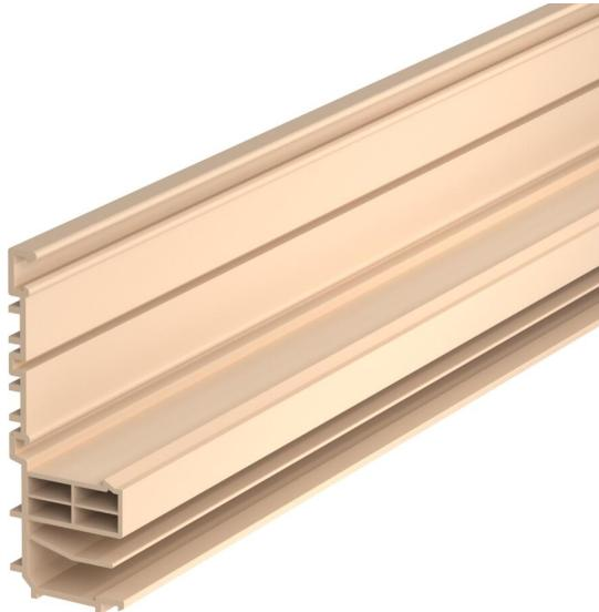
Unterteil des Rauduo-Kanalsystems mit 2 thermisch getrennten Einzelkammern für die gemeinsame Verlegung von Elektro- und Heizungsleitungen. Mit Rastfunktion zur Aufnahme der Kanaloberteile. Die Farbe der Kanalunterteile kann fertigungsbedingt variieren.
