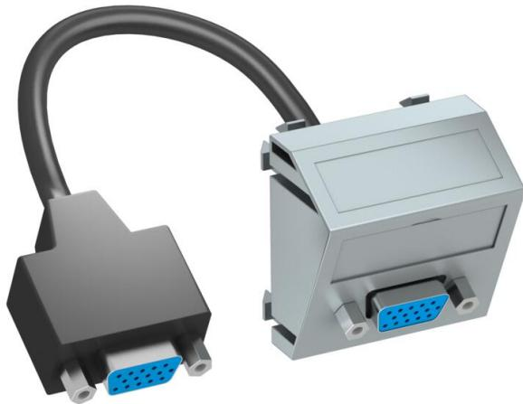
Multimediaträger mit einer VGA-Anschlussbuchse, Kabelauslass schräg, mit Be-schriftungsfeld, kurzes VGA-Anschlusskabel (HD15) in Ausführung Buchse-Buchse. Träger mit Rastbefestigung, geeignet für den waagerechten und senkrechten Einbau in die Systemumgebung.
