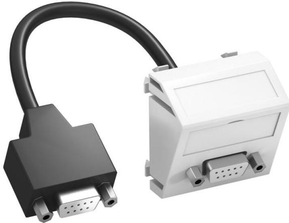
Multimediaträger mit einer D-Sub9-Anschlussbuchse, Kabelauslass schräg, mit Beschriftungsfeld, kurzes D-Sub9-Anschlusskabel (RS232) in Ausführung Buchse-Buchse. Träger mit Rastbefestigung, geeignet für den waagerechten und senkrechten Einbau in die Systemumgebung.
