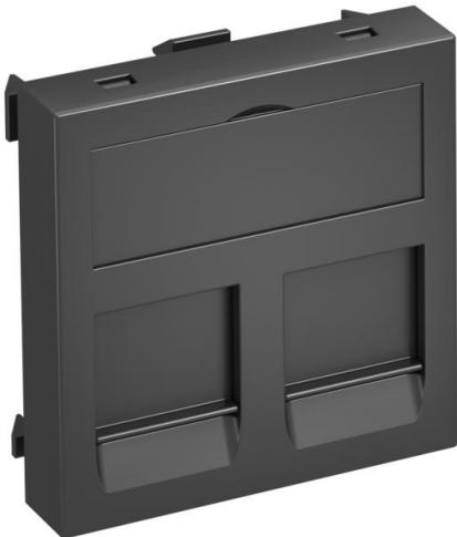
Datentechnikträger mit geradem Auslass und Verschlussriegel zur Aufnahme von zwei Datentechnik-Anschlussmodulen mit RJ45-Buchse. Die Rastbefestigung eignet sich für den waagerechten und senkrechten Einbau in die Systemumgebung. Typ A hat eine Montageöffnung von 20,10 x 14,80 mm und ist für die direkte Befestigung der Daten-Anschlussmodule in der Montageöffnung ausgelegt.
