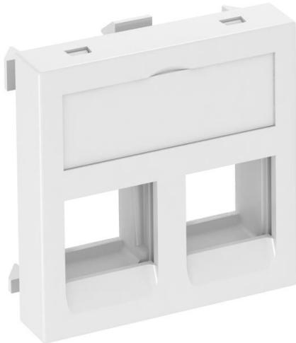
Datentechnikträger mit geradem Auslass, ohne Verschlusschieber, zur Aufnahme von zwei Datentechnik-Anschlussmodulen mit RJ45-Buchse. Die Rastbefestigung eignet sich für den waagerechten und senkrechten Einbau in die Systemumgebung. Typ C hat eine Montageöffnung von 19,30 X 14,80 mm und ist für die direkte Befestigung der Daten-Anschlussmodule in der Montageöffnung ausgelegt.
