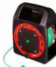
Verlängerungsleitung 30 m, grün, auf praktischer Kabeltrommel, doppelt isolierte Silikonleitung, ideal für die Isolationsmessung, sowie zur Messung von Schutz- und Potentialausgleichsleiter, Strombelastung max. 20 A, Anschluss: Ø 4 mm Sicherheitsprüfbuchse/-stecker
