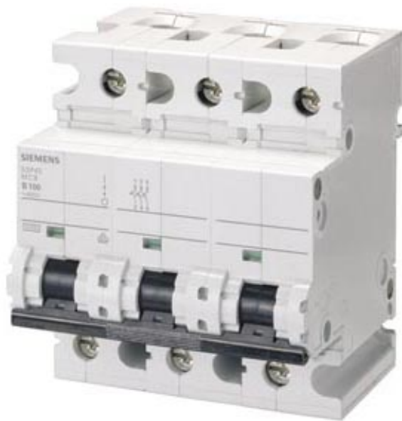
LEITUNGSSCHUTZSCHALTER 400V 10kA, 3POLIG, B, 125A, T=70MM
